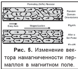
Рис. 5. Изменение вектора намагниченности пермаллоя в магнитном поле.
