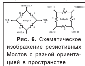
Рис. 6. Схематическое изображение резистивных Мостов с разной ориентацией в пространстве.
